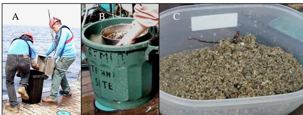
Figure 17 : Les différentes étapes du prélèvement benthos à bord du N/O l' Europe lors la campagne 2006 (Ifremer, 2006) : Récupération de la benne contenant le sédiment prélevé (A); Tamisage du prélèvement sur maille de 1mm (B) ; Refus de tamis avant passage au formol neutralisé (C).
