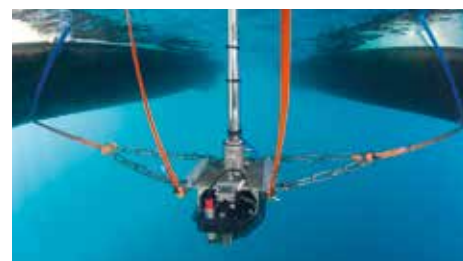
Réalisation de campagnes d'acquisition bathymétrique (sondeur multifaisceaux GéoSwath).
