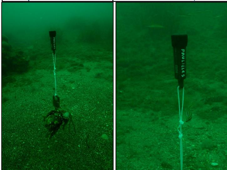
Figure 20: Illustration du capteur de température - site Paulilles (2018).
