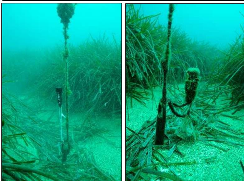
Figure 36: Illustration du capteur de température (nouveau à gauche et ancien à droite) - site Carry (2018).
