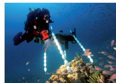
40 photographies de quadrats de 50x50 cm sont réalisées sur une même profondeur (station) le long d'un transect de 20 mètres.
