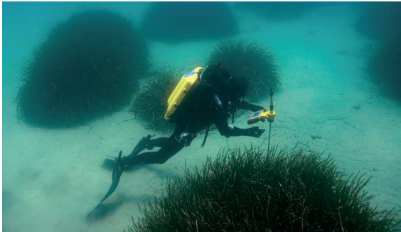
La méthode choisie pour la surveillance de l'herbier à posidonie en limite inférieure consiste en une cartographie par télémétrie acoustique. Le plongeur utilise un pointeur muni d'un mini clavier et d'un écran pour positionner précisément les limites de l'herbier.
