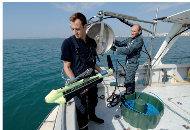
Des campagnes d'acquisition sonar (Klein 3900) pour les eaux plus profondes (<15 mètres) ont été menées pour réaliser la cartographie continue des habitats marins.
