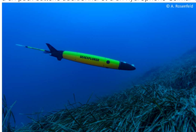
Glider SeaExplorer équipé dans son nez avant d'une charge utile acoustique sur le site de la baie de la Ciotat en 2016
