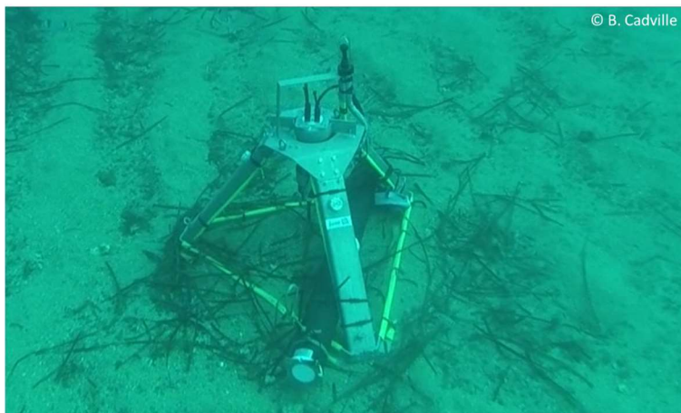
Station de mesure continue du cap Couronne équipée d'un enregistreur SDA 14, d'un pack batterie additionnel et d'un hydrophone Colmar 1280
