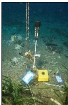
Figure 89 : Données et photo du capteur posé en 2020 en limite inférieure
