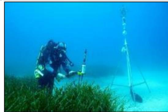
Figure 10: Plongeur cartographiant la limite inférieure de la Posidonie à l'aide du pointeur de l'aquamètre.
