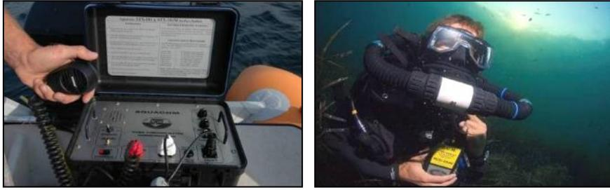
**Figure 8 : Station surface munie d'un hydrophone; à droite : plongeur en recycleur avec le masque facial lui permettant de communiquer avec la surface.**
