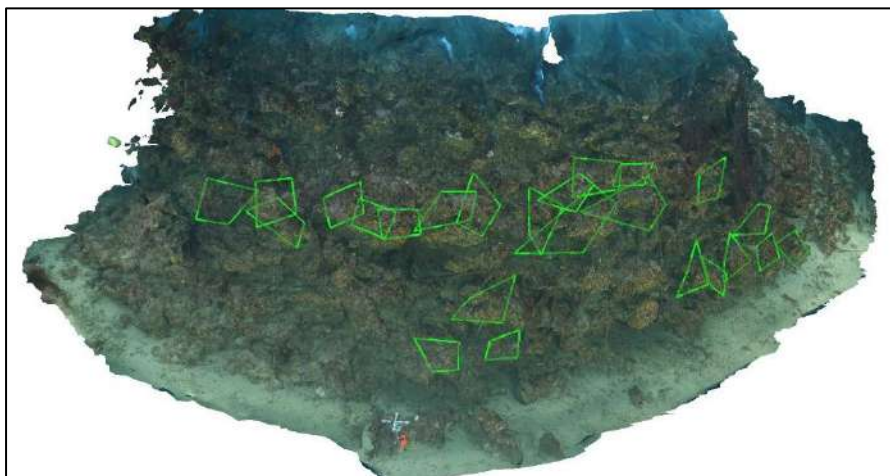
Figure 39 : Positionnement d'une partie des quadrats photographiques (en vert) sur le modèle photogrammétrique en 2021.
