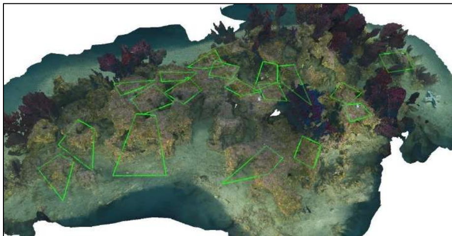
Figure 88 : Positionnement d'une partie des quadrats photographiques (en vert) sur le modèle photogrammétrique en 2021.
