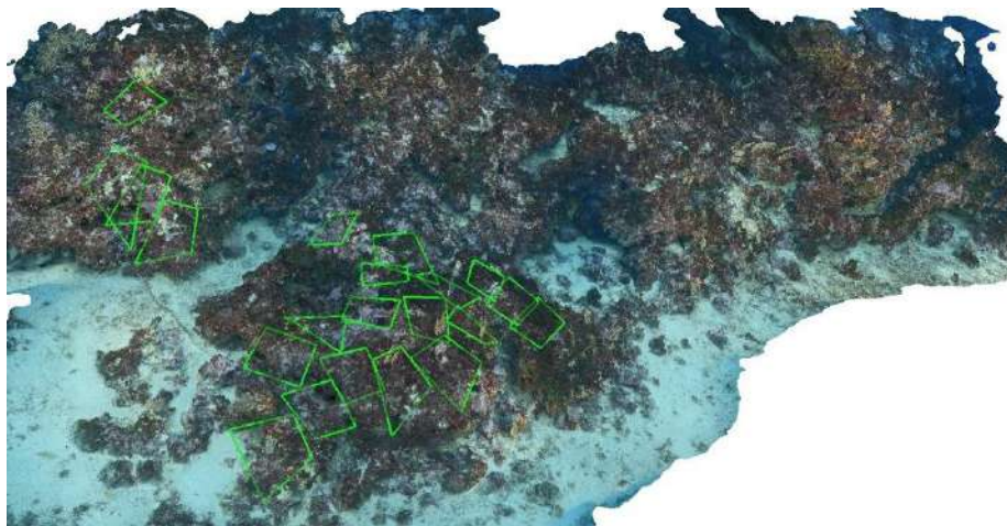
Figure 72 : Positionnement d'une partie des quadrats photographiques (en vert) sur le modèle photogrammétrique en 2021.
