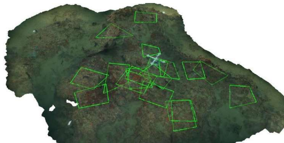
Figure 16 : Positionnement d'une partie des quadrats photographiques (en vert) sur le modèle photogrammétrique en 2021.
