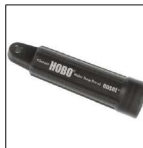
Les capteurs de température utilisés correspondent au modèle HOBO Water TEMP Pro v2 (figure ci-contre). Ces enregistreurs de température, étanches jusqu'à 120 mètres et immergeables, ont été paramétrés pour permettre de prendre une mesure toutes les 30 minutes.
