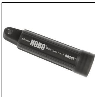
Les capteurs de température utilisés correspondent au modèle HOBO Water TEMP Pro v2 (figure ci-contre). Ces enregistreurs de température, étanches jusqu'à 120 mètres et immergeables, ont été paramétrés pour permettre de prendre une mesure toutes les 30 minutes.
