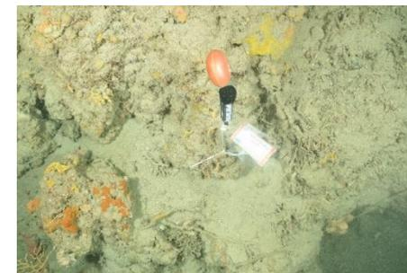
Figure 52 : Pose d'un nouveau capteur en 2022 à -62m sur le site Tombant des Américains Ouest.
