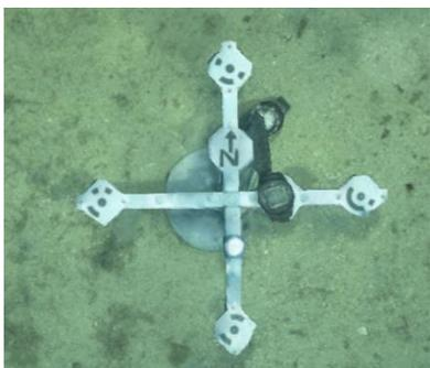
A défaut du **positionnement GPS** des images sous l'eau comme c'est le cas en surface, l'orientation dans l'espace (horizontalité et direction du Nord géographique) ainsi que l'échelle du modèle doivent être contraintes par l'utilisation d'une **mire photogrammétrique** (voir figure ci-contre).
