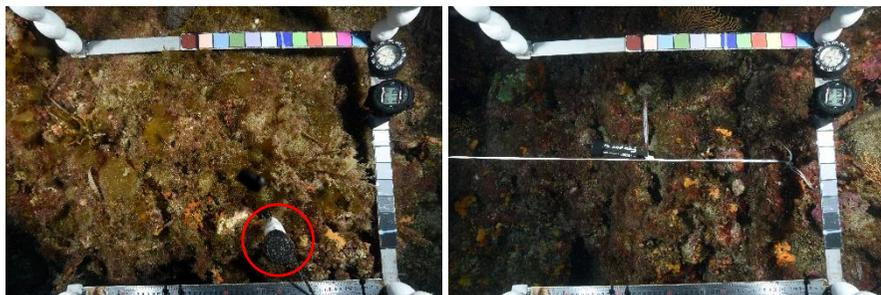
Figure 25 : Capteur de température (à gauche : ancien capteur entouré d'un cercle rouge et à droite : nouveau capteur posé en 2022).
