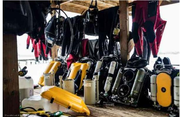
Figure 31 : Scaphandres recycleurs à gestion électronique pour les plongées longues et profondes. Source : Andromède Océanologie.
