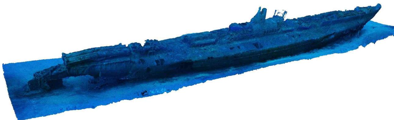
Figure 9 : Modèle 3D de l'épave du sous-marin le Rubis dans le Var qui repose par 40 mètres de fond. Source : Turtle Prod/Seaviews.
