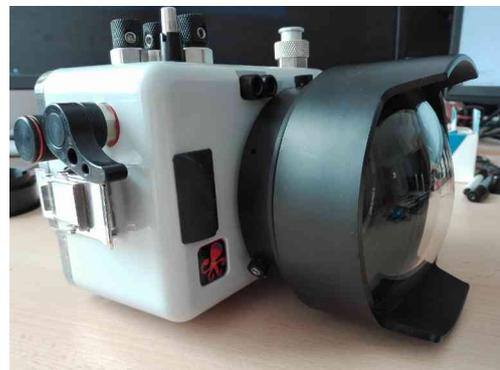
Figure 16 : Un appareil photo hybride avec une optique de focale courte dans un caisson muni d'un dôme. Source : Seaviews.
