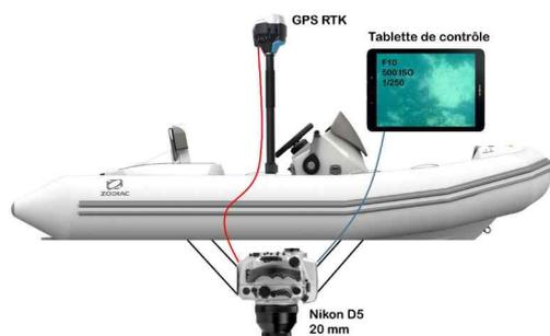
Figure 23 : Appareil d'acquisition photogrammétrique de surface motorisé. Source : Andromède Océanologie.
