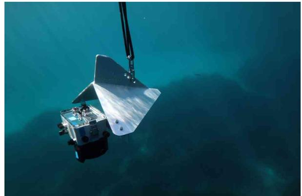
Figure 29 : Dispositif tracté constitué d'une aile en métal sur lequel est fixé un appareil photo. Source : Seaviews.
