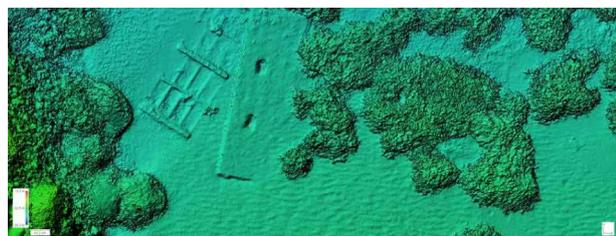
Figure 47 : Exemple de MNT haute résolution d'une portion d'herbier de posidonies au pied d'une digue portuaire.
