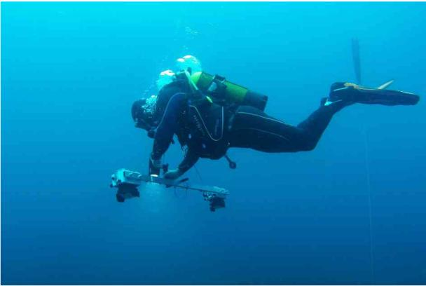
Figure 19 : Dispositif de prises de vues en plongée avec deux APN synchronisés et un phare. Source : Seaviews.
