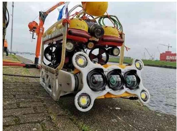
Figure 33 : ROV équipé du système Orus3D de la Comex spécialement dédié à la photogrammétrique sous-marine. Source : Comex.
