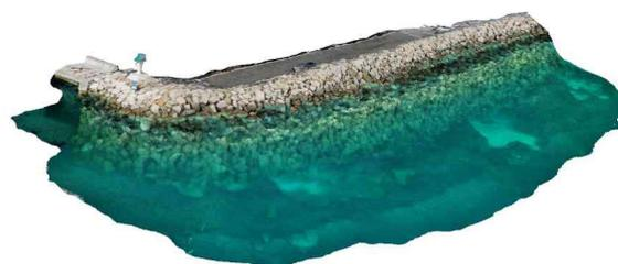
Figure 8 : Modèle 3D fusionnant des photographies terrestres et sous-marines de la digue du port de plaisance de La Ciotat. Ce type de représentation permet d'étudier l'évolution des blocs composant la digue ainsi que les habitats marins à proximité (ici un herbier de posidonies). Source : Seaviews.
