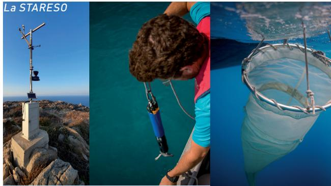
1) Mât météorologique. 2) Déploiement d'une des sondes multiparamétriques. 3) Déploiement d'un filet de zooplancton.
