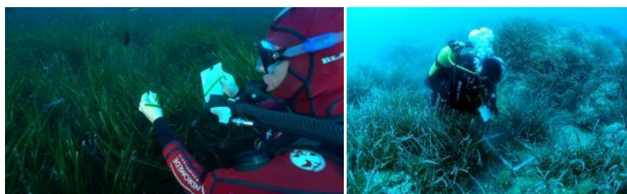
Figure 18 : [1] Plongeur mesurant la longueur des feuilles ; [2] Plongeur évaluant la densité de faisceaux dans un quadrat de 40 x 40 cm
