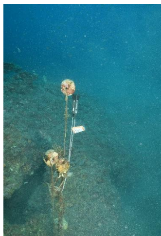
Figure 106 : Données et photo du capteur de température en limite inférieure de l'herbier (2023).
