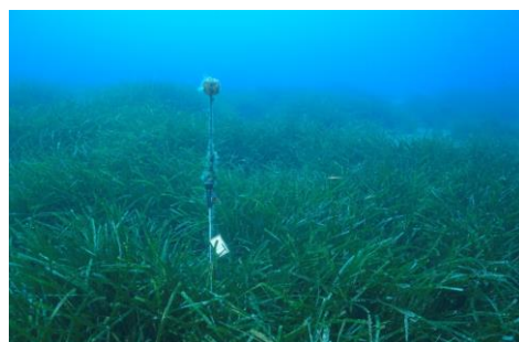
Figure 60 : Données et photo du capteur de température posé en limite d'herbier inférieur (2023).
