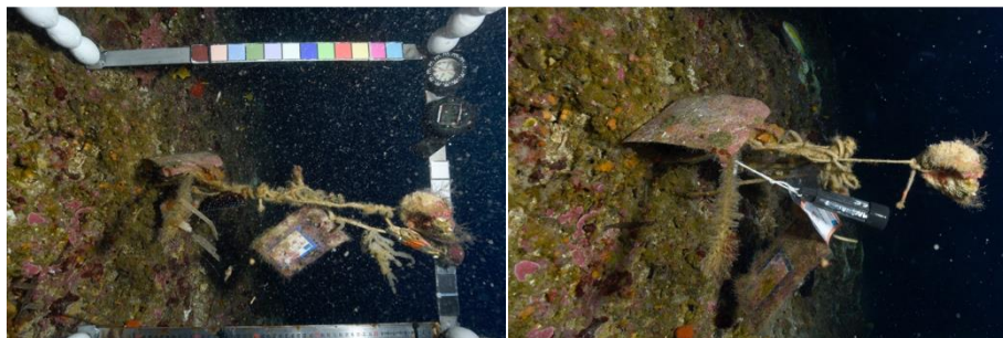
Figure 85 : Site Macinaggio, (2023), - 65 m. [1] Ancien capteur et [2] nouveau capteur de température.
