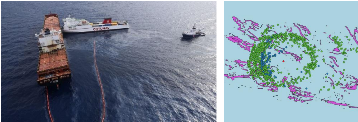
Figure 37 A gauche : Vue aérienne de la collision (source : www.lexpress.fr ). A droite : Positions AIS des deux navires à l'évitement (vert et bleu), position estimée de l'ancre (rouge) et massifs coralligènes (violet).
