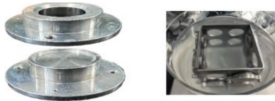
Figure 8 : nouvelle échantillonneur DGT pour la mesure de HAP dans les sédiments (Rong et al., 2024).
