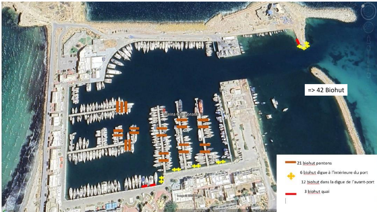
Figure 18: Plan d'installation des Biohut
