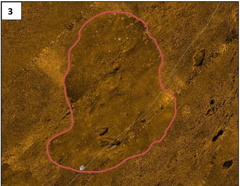
Figure 25 : Extraits des données sonar 2020 acquises au nord de l'île de Porquerolles. Les grandes taches de matte morte probablement causées par des impacts d'obus pendant la Seconde Guerre Mondiale sont délimitées par les traits orangés. Les surfaces de ces pertes d'herbier sont comprises entre 5000 m<sup>2</sup> et 25 hectares.
