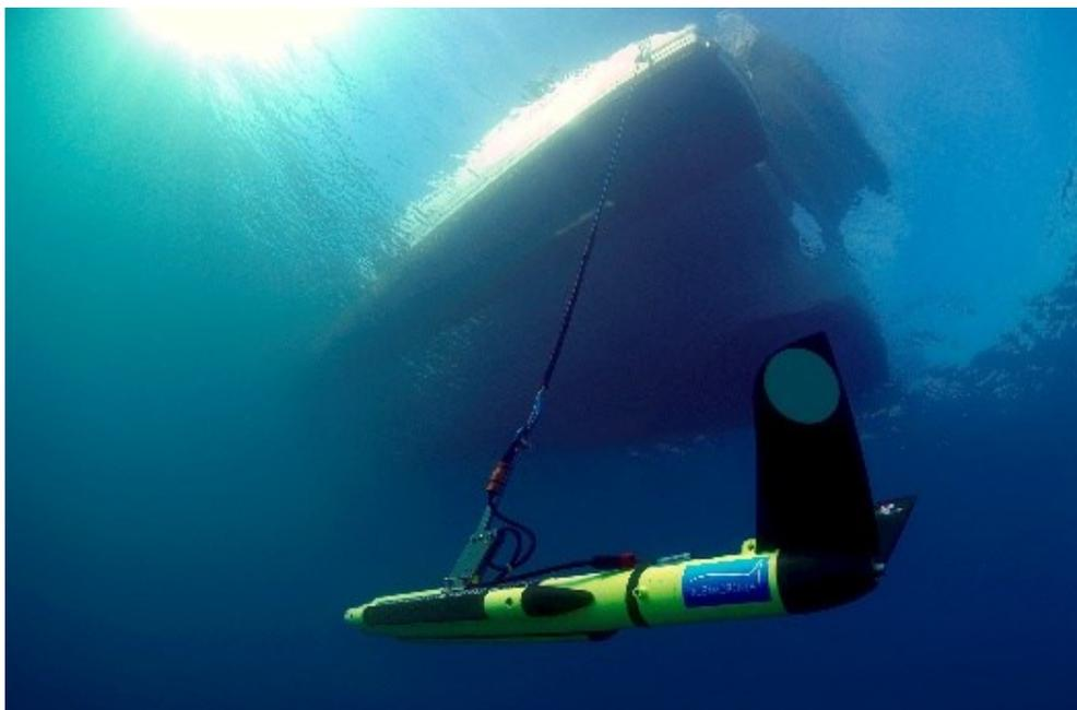
*Figure 6 : Sonar Klein 3900. A gauche : micro-ordinateur avec logiciel SonarPro et enregistreur numérique ; à droite : poisson relié au bateau par le câble électroporteur. Source : Andromède*
