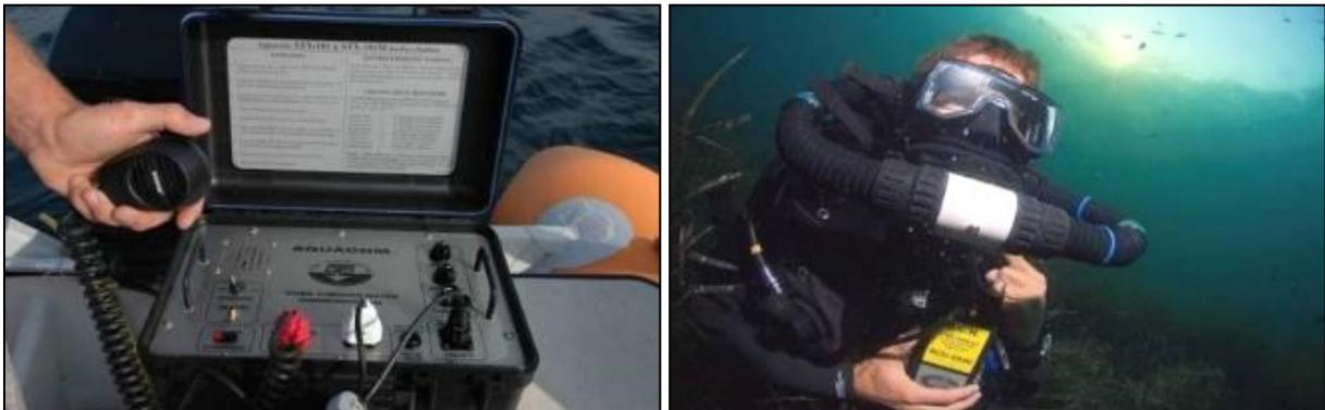
*Figure 7 : Station surface munie d'un hydrophone ; à droite : plongeur en recycleur avec le masque facial lui permettant de communiquer avec la surface.*
