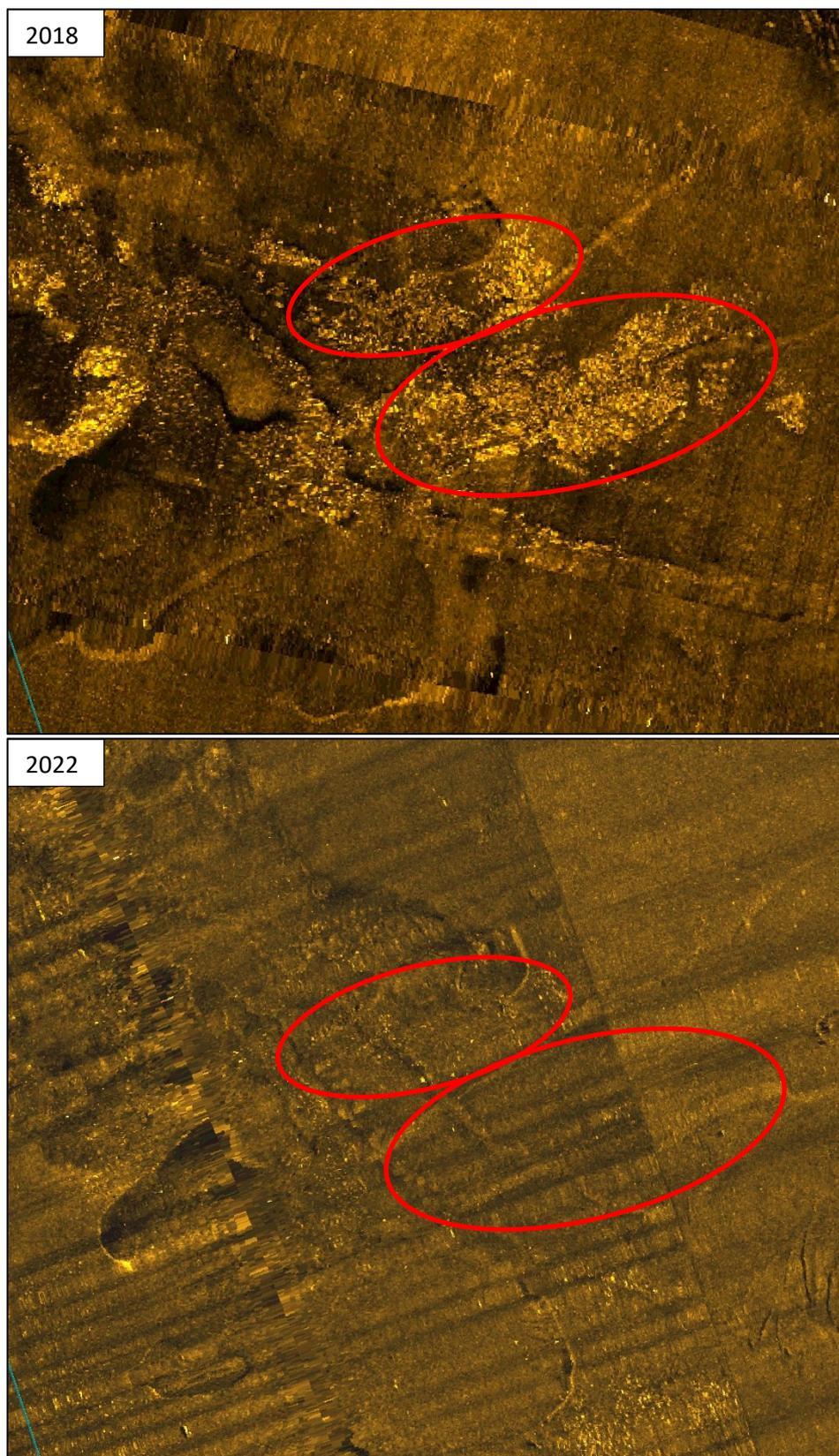
Figure 76b : Comparaison des données sonar de 2018 (en haut) et de 2022 (en bas). On peut observer deux nouvelles zones de matte morte sur le sonar acquis en 2022 (cercles rouges) probablement causées par l'ancrage de navires dans cet herbier entre 2018 et 2022. On peut toujours constater la présence de faisceaux dans le 1<sup>er</sup> cercle de la 2<sup>nd</sup>e image mais la densité y a été fortement diminuée (labourage par les chaînes des ancres).
