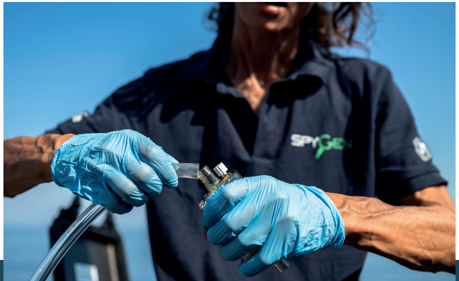
Fixation du tuyau sur la capsule de filtration © Greg Lecoeur, WE ARE MÉDITERRANÉE
