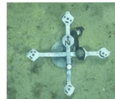
Celle-ci est disposée en début d'acquisition par le plongeur, correctement orientée dans l'espace, et les **cibles codées à ses quatre extrémités cardinales** sont reconnues par le logiciel de traitement et permettent l'orientation et la mise à l'échelle du modèle. La mire pour le coralligène mesure 50 cm de long.
