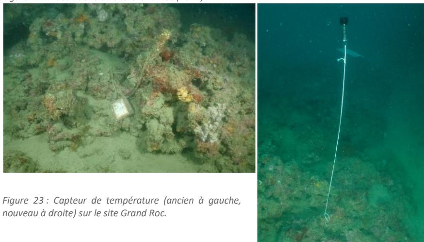
Figure 23 : Capteur de température (ancien à gauche, nouveau à droite) sur le site Grand Roc.
