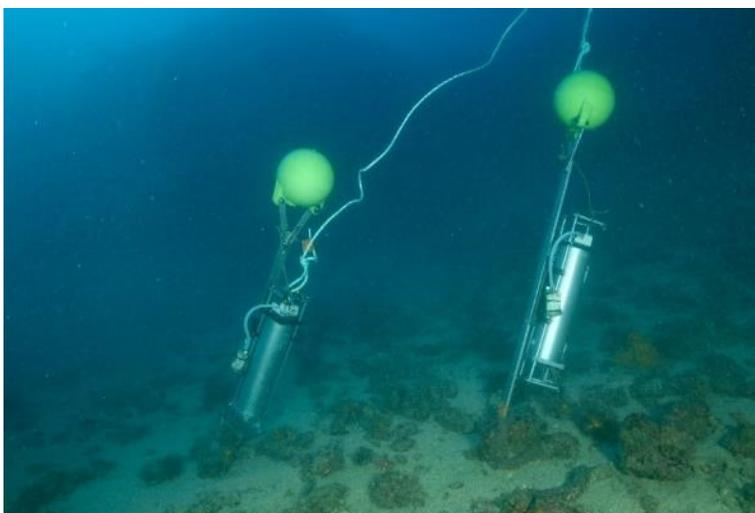
Figure 72 : Pompes de filtration sur le site Tiboulen à -40 m en 2024.
