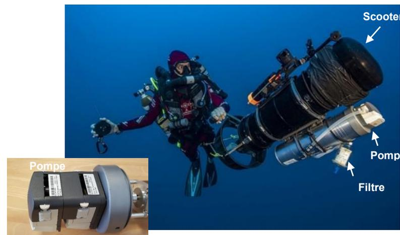
Figure 13 : Pompe étanche conçue par Andromède Océanologie et l'Université de Montpellier.
