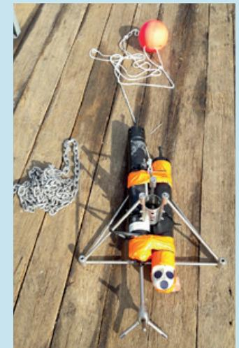
Un ADV et un AQP sur le pont du bateau, en attente d'être posés sur un anneau.
