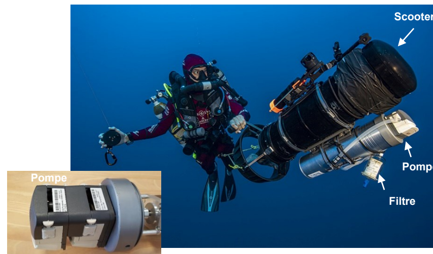
Figure 21 : Pompe étanche conçue par Andromède Océanologie et l'Université de Montpellier.
