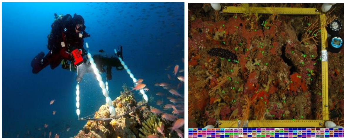
FIGURE 51 : ILLUSTRATION DE L'ACQUISITION ET TRAITEMENT DES QUADRATS PHOTOGRAPHIQUES RECOR
