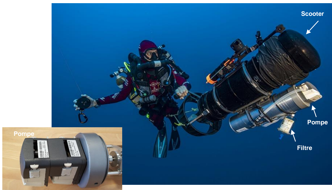
FIGURE 84 : POMPE ETANCHE CONÇUE PAR SUBSPACE, ANDROMEDE OCEANOLOGIE ET L'UNIVERSITE DE MONTPELLIER.
