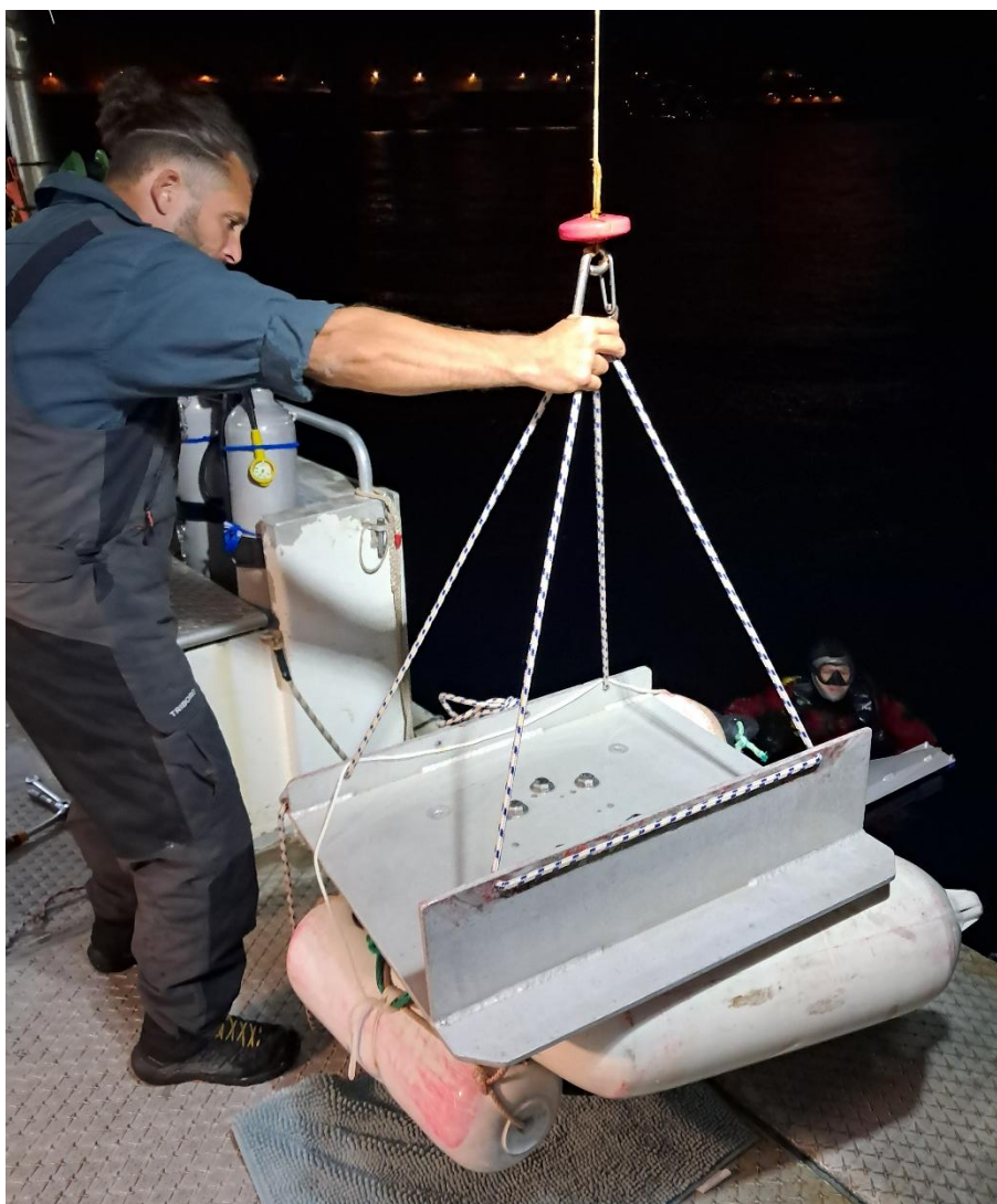
Figure 17 : Installation du sondeur à sédiments en plongée après neutralisation de sa flottabilité
